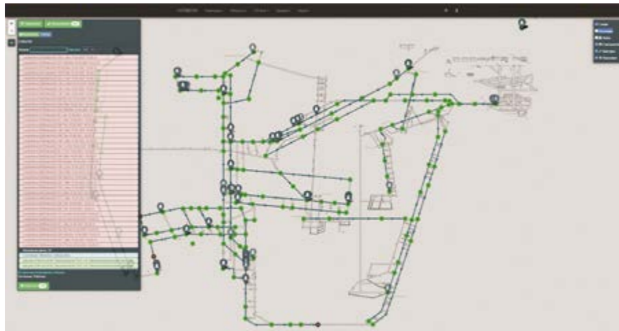
Работа системы позиционирования комплекса «Горизонт» на экране АРМ диспетчера
